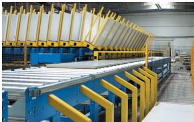
Hennecke. Линия оснащена комплектующими ведущих европейских производителей. В качестве исходного сырья для получения утеплителя применяются компоненты (полиолы, полиизоцианаты, катализаторы), изготовленные по технологии концерна Bayer. Линия оснащена компьютерными технологиями, позволяющими строго выдерживать технологический регламент, что является гарантией стабильных физико-механических показателей PIR/PUR.
