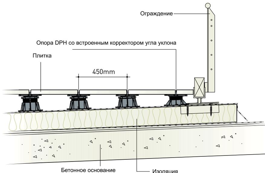
опор защищает гидроизоляционный слой основания от многократных механических нагрузок и воздействия УФ излучения. Эта же особенность позволяет свободно циркулировать воздуху под террасным покрытием, что способствует высыханию поверхности гидроизоляционного слоя и, соответственно, увеличению его срока эксплуатации.
